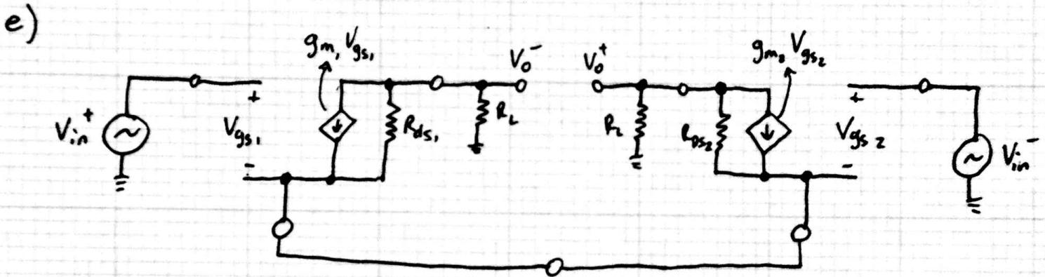
f)  $V_{in}^+ = (1\text{mV}) \cos(2\pi \cdot 1\text{kHz} \cdot t)$  ,  $V_{in}^- = (0.5\text{mV}) \cos(2\pi \cdot 1\text{kHz} \cdot t)$
